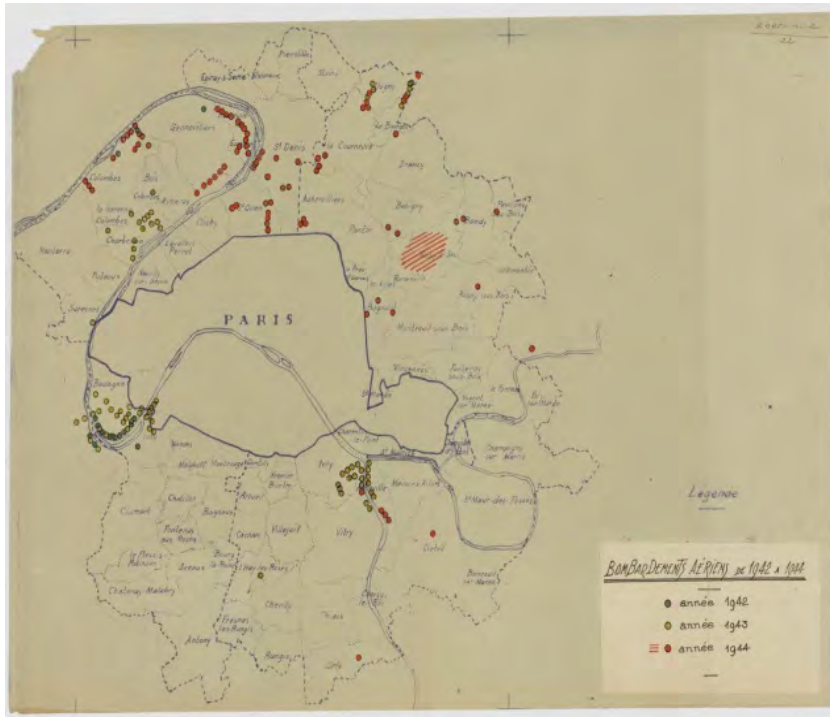
Carte 4. Localisation des réseaux d'assainissement endommagés suite aux bombardements de la seconde guerre mondiale
